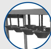
Sistema di bloccaggio per fissare maniche o anilox di diverse altezze
