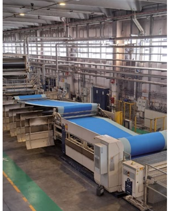
Uno degli impianti per cartone ondulato di LIC Packaging con il caratteristico nastro in tessuto BLUEBACKER di GKD ©LIC Packaging
